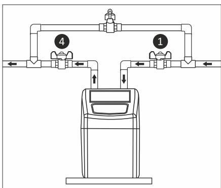
1. подача водопроводной воды (неумягченная вода).
