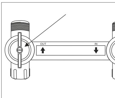
1. Для регулировки остаточной жесткости в (в случае умягчителя) предусмотрен регулировочный винт, который находится (встроен) в заводской байпас в месте выхода воды из клапана:
