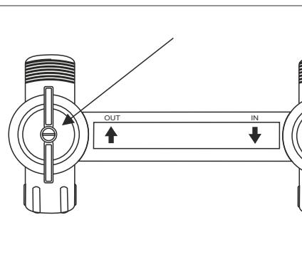
KROK. 1 Wyreguluj twardość w wodzie wyjściowej z urządzenia za pomocą śrubę regulującą zintegrowanej z wyjściowym zaworem fabrycznego obejścia:
