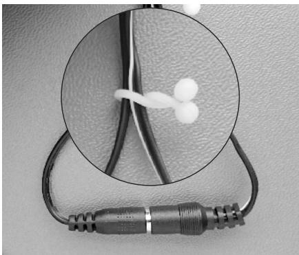
KROK 1. Podłączyć przewody wyjściowe z transformatora do gniazda przewodu zasilającego w urządzeniu; zabezpieczyć go za pomocą zacisku TwistLock.
