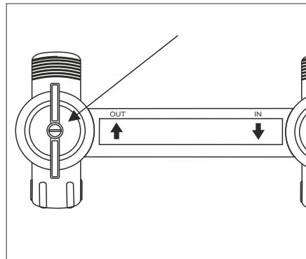
1. Stellen Sie die Resthärte des Wassers ein mittels des Verschneidevents, eingebaut in der Auslassventil der Ab-Werk Bypass:
