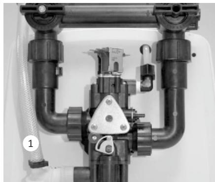
KROK 1. Podłączyć 13 mm wąż do cewki cylindrycznej spustu w zaworze sterującym (1); zabezpieczyć zaciskiem.
