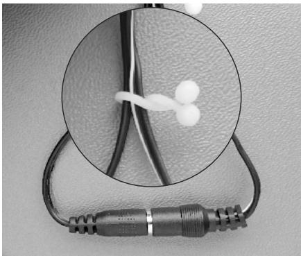
1. Verbinden Sie den Ausgang des Netzteils mit dem Stromkabel der Anlage; sichern mittels der TwistLock Klemme.
